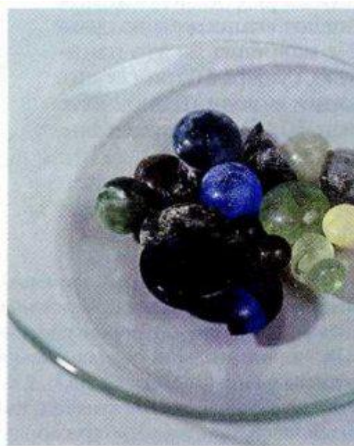
Рис. 1.2. Качественные реакции ионов металлов по окраске перлов
